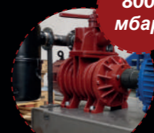
Високовакуумний насос із розрідженням 800 мбар
