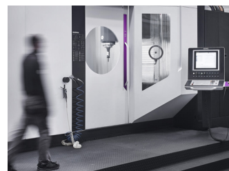
Повністю закрита робоча зона та захисні вікна.
