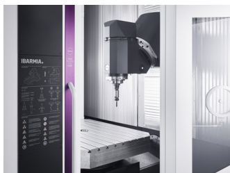
Освітлена робоча зона. Робоча зона без горизонтальних площин та з гладкою поверхнею.
