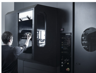
Станція для оперативного ручного завантаження інструментів у магазин.
