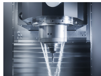
Зовнішня система охолодження навколо шпинделя.
