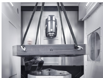
Стандартний відкидний дах, що полегшує завантаження та розвантаження деталей за допомогою крана.
