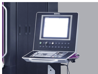
Пересувна панель управління з 19-дюймовим сенсорним екраном.
