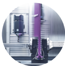
Подвійна двохстороння обертальна балка, що замінює нерухомий стіл.
