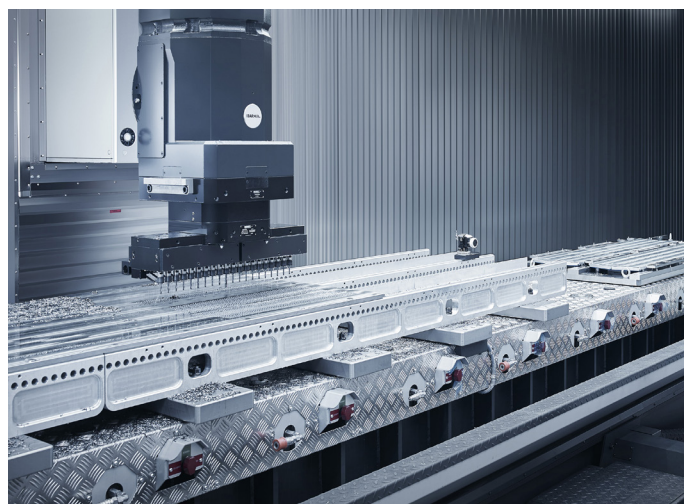
Конфігуруйте нерухомий стіл з гідравлічними з'єднаннями для автоматичних затискних пристроїв.
