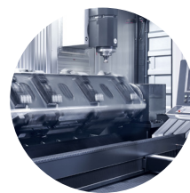
Подвійна чотрьохстороння обертальна балка, що замінює нерухомий стіл.
