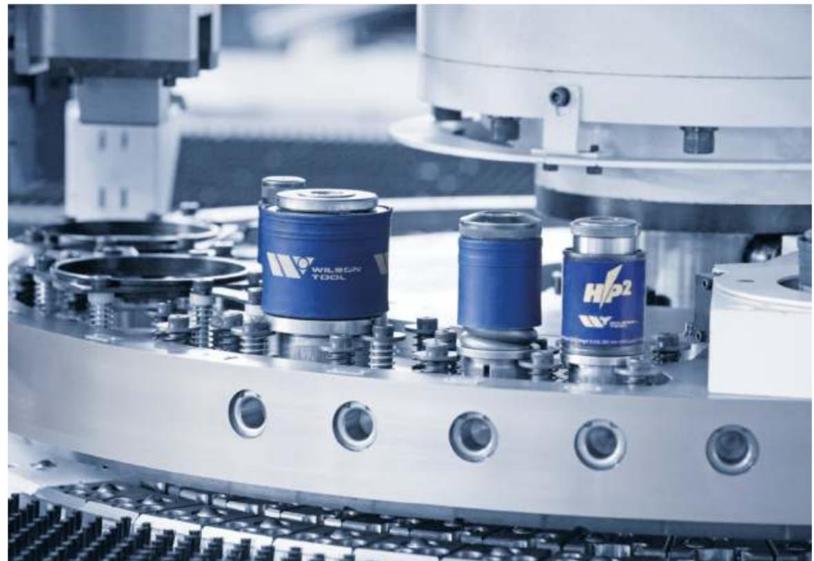
Револьверный координатнопробивной пресс с ЧПУ
