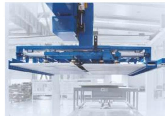
Вакуумное устройство для загрузки/пальцевые упоры для разгрузки
