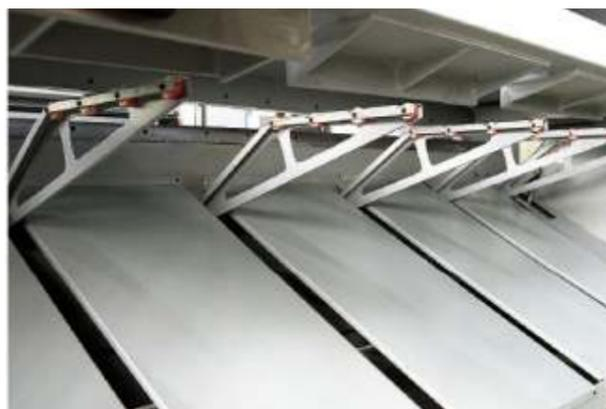
Пневматическая листовая поддержка для позиционирования (стандартная конфигурация для станков до 8x4050)
